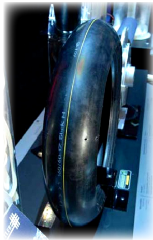
รูปที่ 6 ยางล้อที่มีการใช้นาโนพรีนในสูตรคอมพาวด์ดอกยางที่นำมาแสดงในงาน K ปี ค.ศ. 2007
