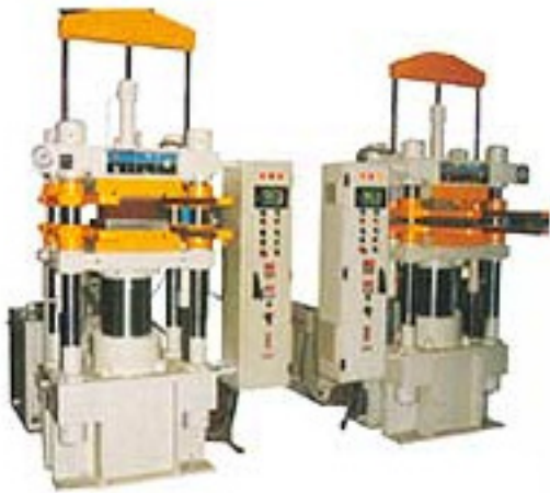
รูปที่ 8 เครื่องจักรแม่พิมพ์แบบกึ่งฉีด (transfer molding machine)
